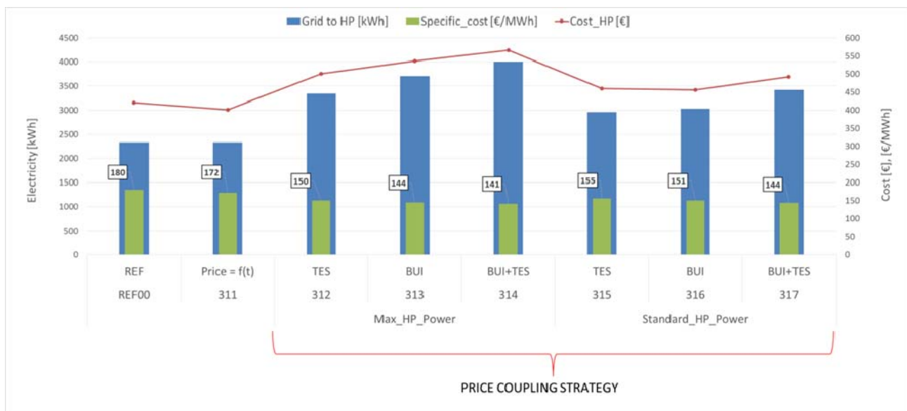
Abbildung 58: Netzstrombetriebskosten für das RES45 (ohne PV) für konstanten (REF) und variable Strompreise (311 bis 317) mit unterschiedlichen Regelungsstrategien zur Preiskopplung.
