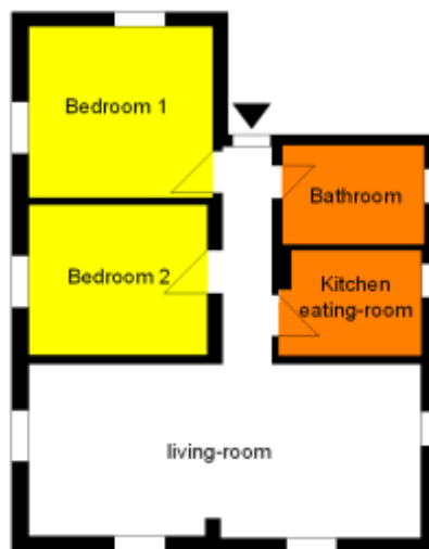
Abbildung 6 Grundriss mit Gefahr von Strömungs-Kurzschluss. Bei der erweiterten Kaskadenlüftung hätte das Wohnzimmer in diesem Beispiel weder Zu- noch Abluft. Die Stärke der natürlichen Luftdurchmischung bzw. die Stärke des Kurzschlusses zwischen den Überströmöffnungen bestimmt, wie gut das Wohnzimmer mit Frischluft versorgt wird. Reproduziert mit Erlaubnis aus [7].
