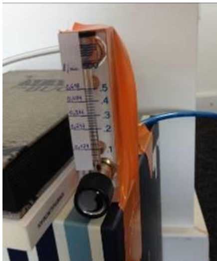
Abbildung 43 Schwebekörper-Durchflussmesser und T-Stück für die Verteilung der CO 2 Quelle aus der Flasche, diese wurde über einen elektronischen Massendurchflussregler (Fa. Bronkhorst, EL-Flow) konstant gehalten
