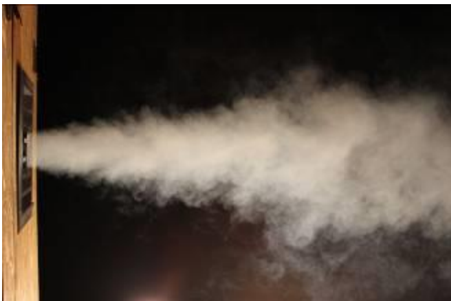
Abbildung 41 Visualisierung der Rückströmung mit Nebel in der Fortluft. Links bei 64 \text{ m}^3/\text{h} , Rechts bei 120 \text{ m}^3/\text{h} .
