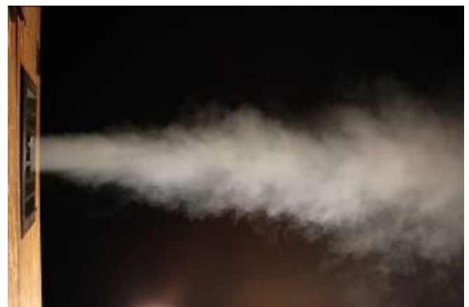
Abbildung 41 Visualisierung der Rückströmung mit Nebel in der Fortluft. Links bei 64 \text{ m}^3/\text{h} , Rechts bei 120 \text{ m}^3/\text{h} .
