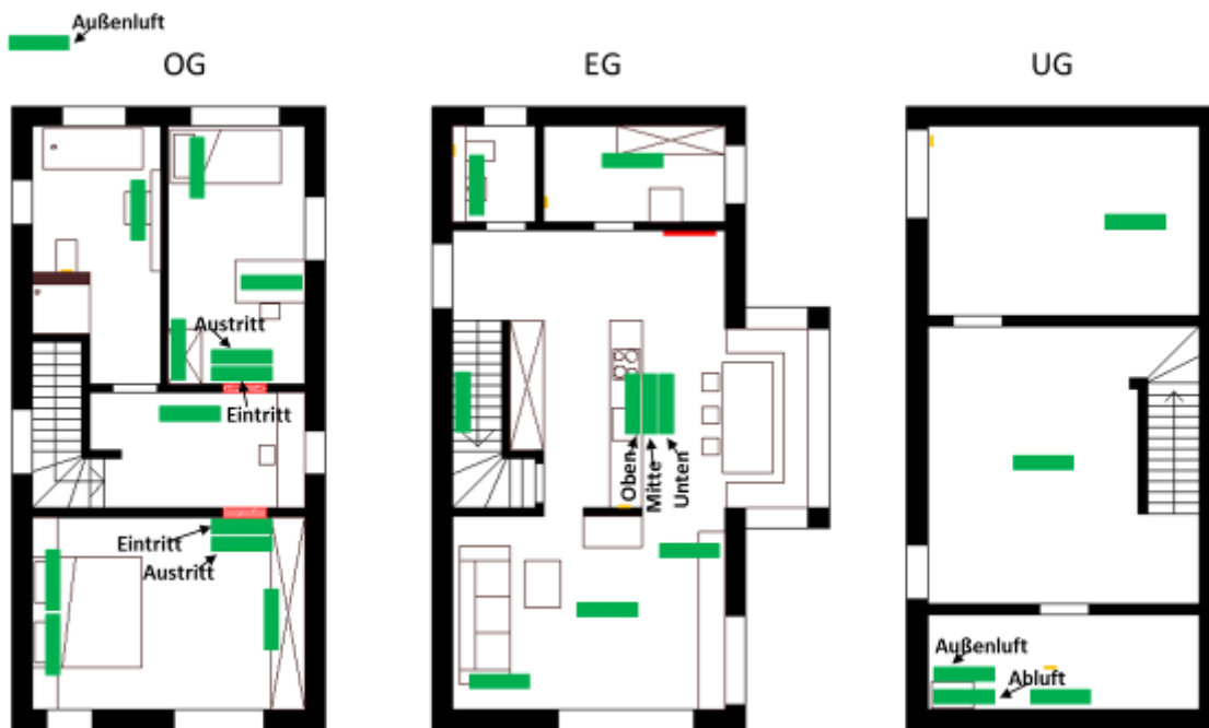
Abbildung 44 Positionen der Data-Logger in dem Haus zur Aufnahme der CO 2 -Konzentration, der Luftfeuchte und der Temperatur
