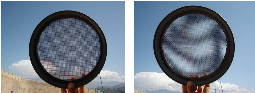
Abb. 3: Die von uns verwendeten Siebe hatten eine Maschenweite von 1000 bzw. 2000 \mu\text{m} .
