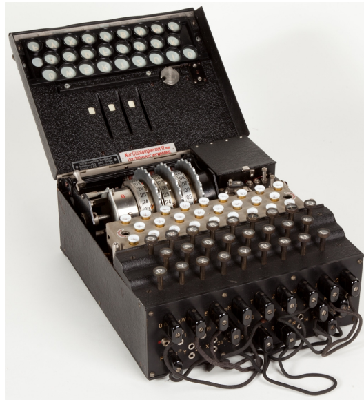
Abbildung 3: Exemplar einer Enigma (Alessandro Nassiri, 2012)
