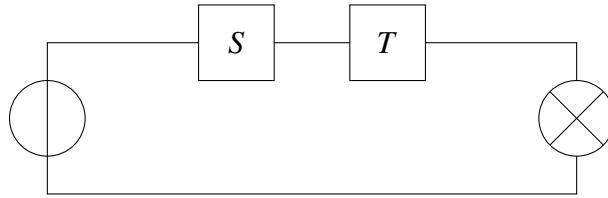
und  $f \vee g$  die Schaltfunktion der „Parallelschaltung“ von  $S$  und  $T$ .
