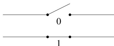
Der *Zustand von  $n$  Schaltern* wird durch ein  $n$ -Tupel in  $\mathbb{Z}_2^n$  beschrieben. Statt Schaltungen können auch elektronische Bauteile mit  $n$  Eingängen und einem Ausgang betrachtet werden.
