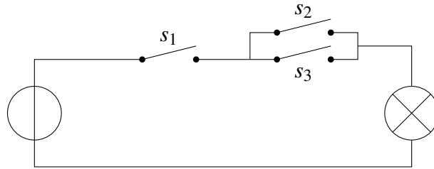
ist  $f : \mathbb{Z}_2^3 \rightarrow \mathbb{Z}_2$ , wobei  $f(z_1, z_2, z_3)$  der Zustand des Verbrauchers ist, wenn  $(z_1, z_2, z_3)$  die Zustände der drei Schalter sind. Zum Beispiel ist  $f(1, 1, 0) = 1$  (es fließt Strom durch den Verbraucher, wenn  $s_1$  und  $s_2$  geschlossen sind und  $s_3$  offen ist).
