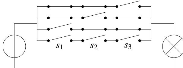
Verwendet man die konjunktive Normalform der Schaltfunktion, so kann die Schaltung als Serienschaltung von 4 Parallelschaltungen mit je 3 Schaltern gebaut werden. Von diesen insgesamt 12 Schaltern sind jeweils 4 (die 4 Schalter oben, die 4 Schalter in der Mitte und die 4 Schalter unten) zu einem Schalter zusammengefasst ( $s_1, s_2$  und  $s_3$ ).
