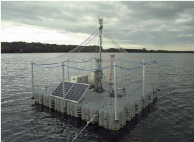
Abb. 1: Messfloß am Arendsee. An diesem Gewässer werden seit 1976 physikalische, chemische und biologische Parameter erfasst (Foto S. Jordan).
