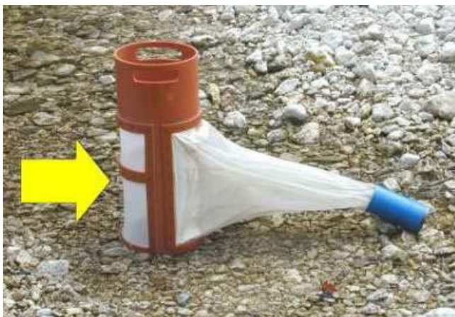
Abb.19: Durchflussrichtung im Lunz-Sampler
