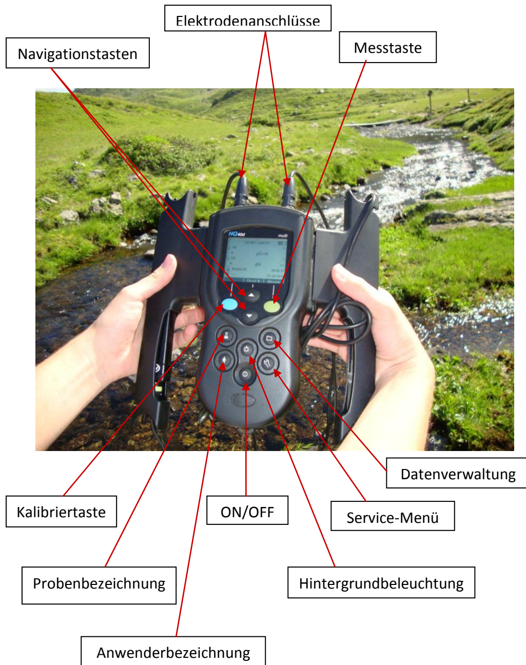
Abb.23: Multisonde HQ40d Multi mit Erklärung der Funktionen
