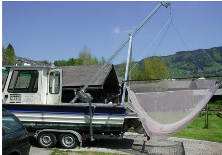
Abb. 19. Schleppnetz an spezieller Kranvorrichtung mit Handkurbel.
