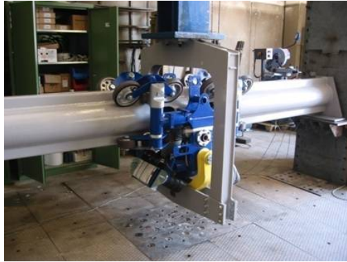
Abbildung 1: Versuchsanordnung zur Bestimmung von Ermüdungsfestigkeiten stählerner Fahrwegkonstruktionen
