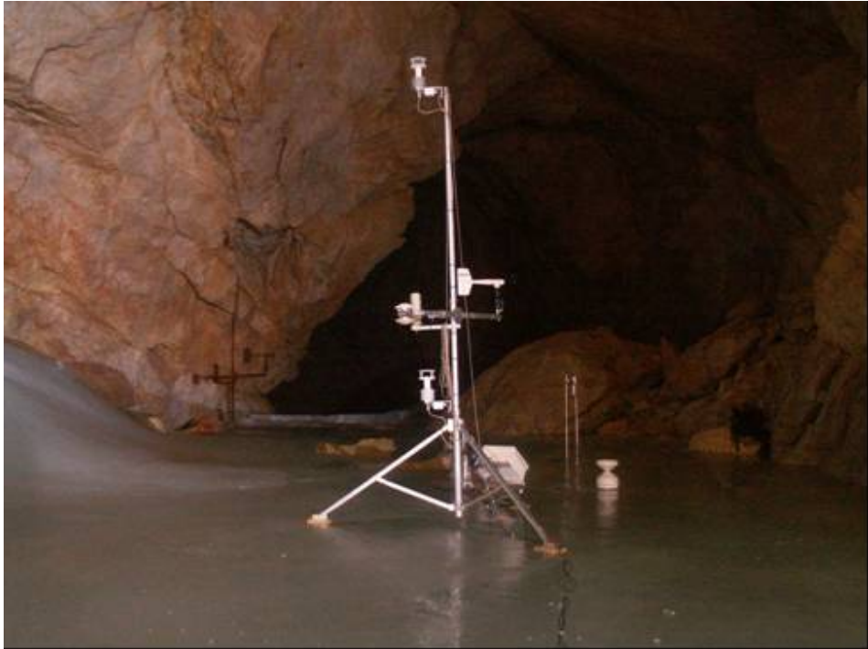
Abbildung 1: Mikrometeorologische Messungen in einer Eishöhle
