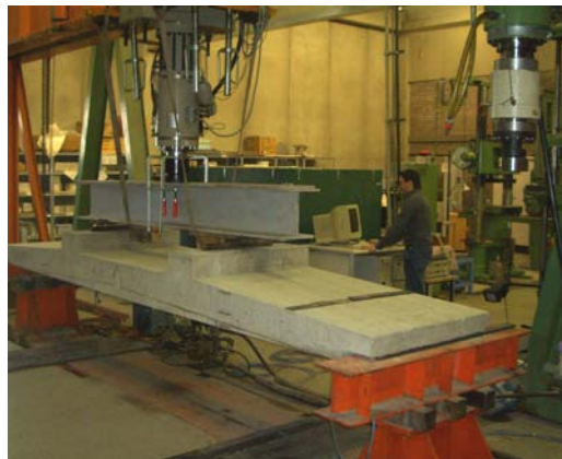
Abbildung 3: Versuchsaufbau zur Durchführung der Bauteilgroßversuche an mittels Aufbeton verstärkten Brückenquerschnitten
