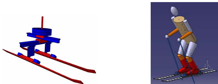
Abbildung 2. Mehrkörpermodell eines Skifahrers
