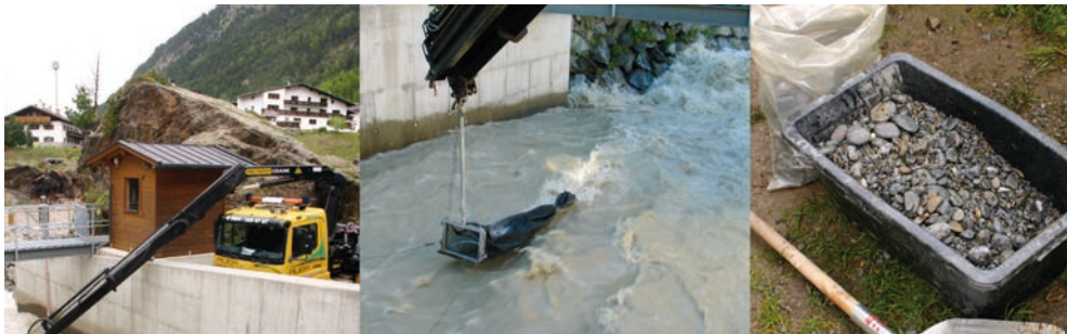
Abb. 20: Geschiebemessung mit einem mobilen Geschiebefänger (a, b) und die erschrotete Geschiebeprobe (c) am Pegel Vent/Rofenache (Fotos: Hugo Seitz, Institut für Wasserwirtschaft, Hydrologie und Konstruktiven Wasserbau, IWHW, an der BOKU/Wien)
