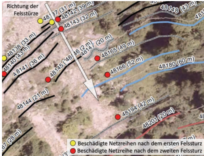
Abbildung 1, Darstellung der verschiedenen Schutzbauwerke bestehend aus flexiblen Netzkonstruktionen gegen Steinschlag und Lawinen im Felssturzgebiet
