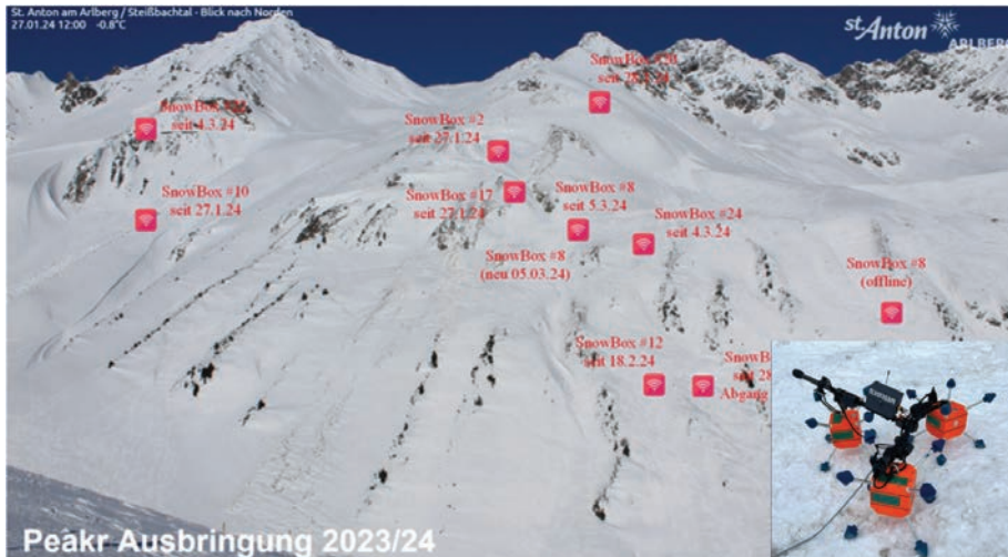
Abbildung 5: Sensornetzwerk der Schneesensorik „peakr“ dient der Ermittlung des Risikos zu Gletschneeeabbrüchen (Messung Temperatur, Feuchte, Bewegung) sowie zur Echtzeit-Detektion von Schneebrettabbrüchen (Beschleunigungsmessung). Zweck: Gletschnee- und Lawinendetektion sowie der Unterstützung der Lawinenkommission. Aktualisierung: minütlich bis stündlich für 6 Monate. Status: Anwendungstest.
