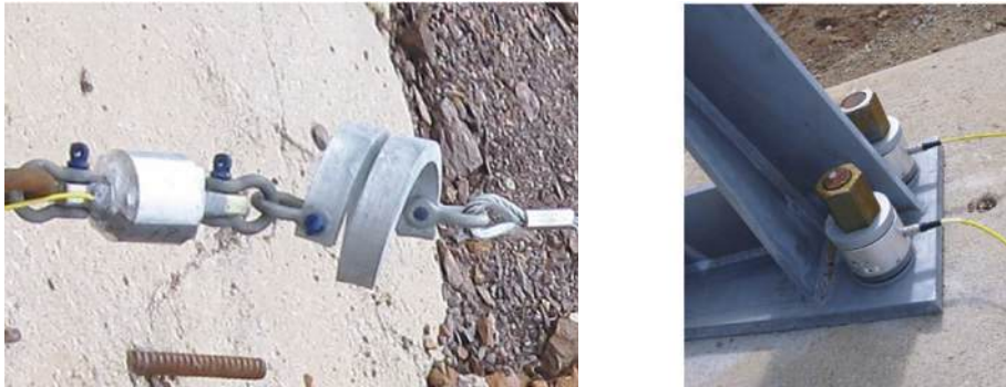
Abb. 1: Kraftmessungen an Seilenden (links) und am Stützenfuß eines Steinschlagschutzsystems ohne bergseitiger Abspannung (rechts)
