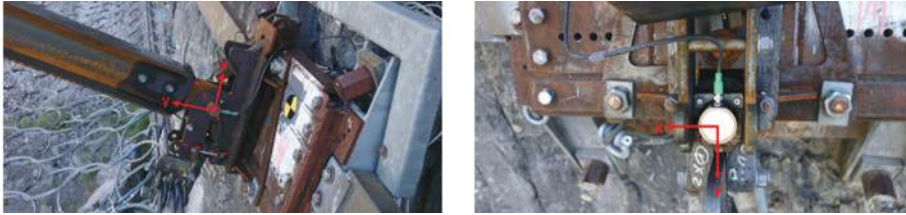
Abb. 2: Messung der Stützen Druckkraft sowie Schubkräfte mit zwei Zweiachsigen Kraftmessbolzen
