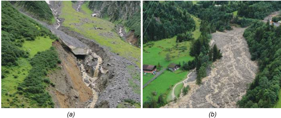
Abb. 9: (a) Stark verkleinerte bis vollständig fehlende Firnfelder am Kegelhals, (b) Ablagerungen der Murgänge in der Aare unterhalb der Eimündung des Spreitgrabens. Das Gerinnebett hat sich dort seit 2009 um über 20 m angehoben.
