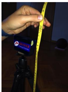
Abb. 2: Höhe Startlichtschranke Start (40cm)
