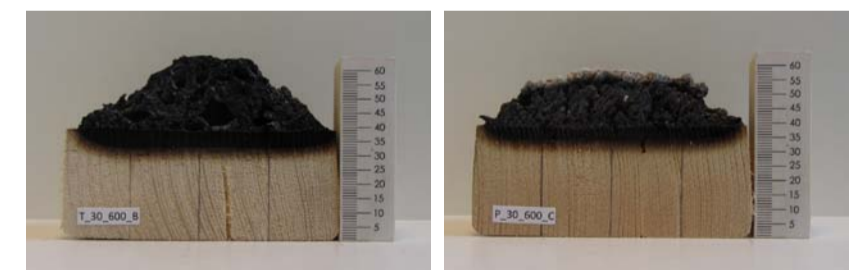
Charakteristische Schaumbildung links: transparente Beschichtung rechts: pigmentierte Beschichtung
