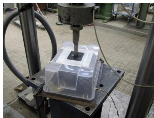
Versuchsaufbau mit Klimatisierung
