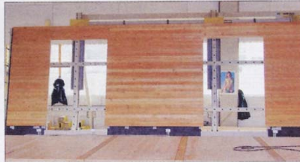
Die Bauelemente werden im Werk vorgefertigt und genau kontrolliert. Am Messstand prüfen die Forscher, ob die Konstruktionen den Schallschutz-Vorgaben entsprechen.
