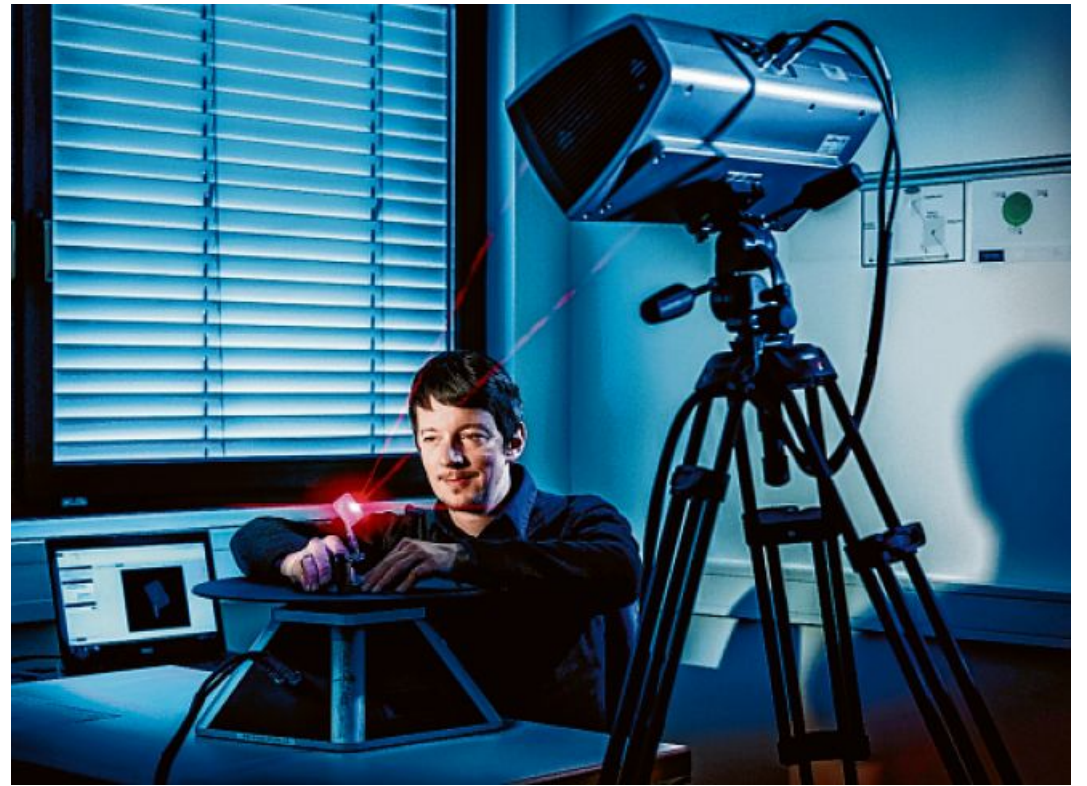
Mithilfe eines 3D-Scanners bemisst Mathias Kirschner die Formgenauigkeit der produzierten Teile. Foto: kdg opticom
