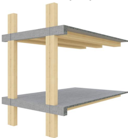
Abb.2: Hybridkonstruktion des Life Cycle Towers, A
