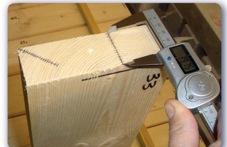
Messung „mittlere Jahringbreite“ mittels Schieblehre
