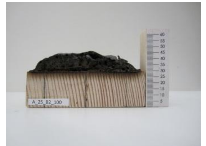
Aufgeschäumte Probe nach Versuchsdurchführung
