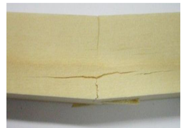
Bruchbild nach der Biegeprüfung
