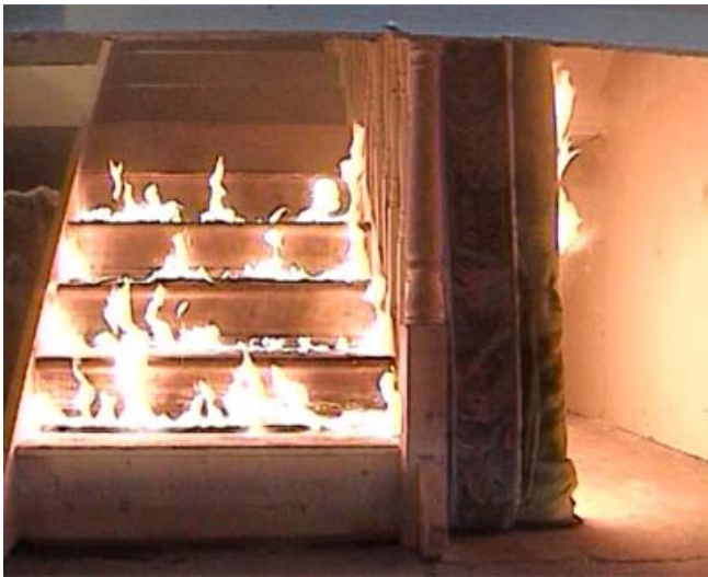
Foto: Brandversuche an Stiegen / Julie BREGULLA
