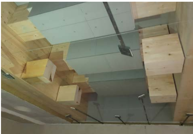
Prüfung der HVP-Verbinder bei der Technischen Versuchs- und Forschungsanstalt der Universität Innsbruck
