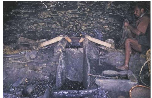
linkes Bild: Traditioneller Kupferschmelzofen in Sikkim Himalya, Indien, 19. Jahrhundert (Percy 1861) rechtes Bild: Traditioneller Kupferschmelzofen in Okharbot, Nepal, 1995 (Anfinset 2011)
