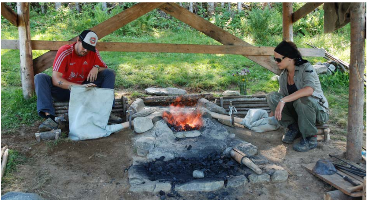
Experiment zur Kupfergewinnung aus Kupferkies nach traditionellen Verfahren aus Nepal
