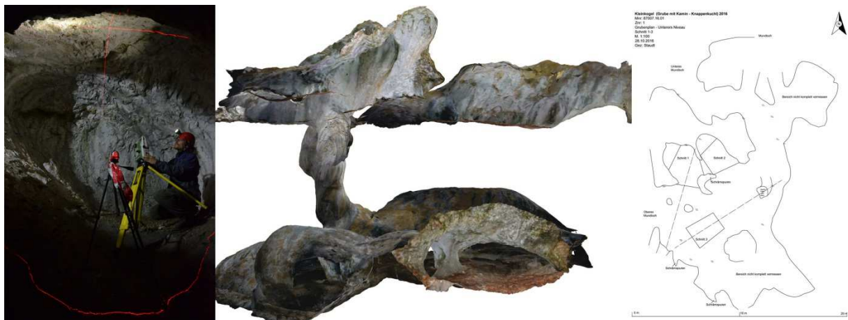
Abb. 7: Vermessungsarbeiten unter Tage, dreidimensionales Grubenmodell und Grubenplan der Grube „Knapenkuchl“.
