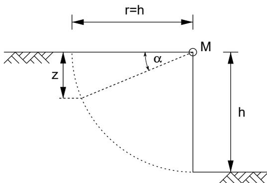
Für eine senkrecht Böschung in einem Material mit  $\gamma$ ,  $c$  und  $\varphi$  wird ein Gleitkreis als Versagensmechanismus angenommen.
