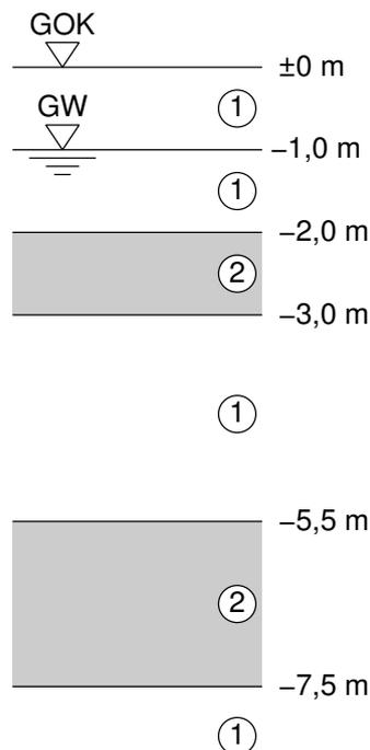
In dem nebenstehend abgebildeten Boden wird eine Fundamentplatte mit einer Fläche von 2 m mal 4 m und einer von Dicke 0,5 m eingebunden, so dass die Fundamentsohle auf -0,5 m zu liegen kommt. Der Untergrund besteht aus einer Wechsellagerung von Kies (Boden 1) und Ton (Boden 2) mit den angegebenen Schichtgrenzen. Der Grundwasserspiegel liegt bei -1,0 m. Das Fundament wird über eine Wandscheibe mit  $N = 2781$  kN belastet, und ist somit als starr anzusehen.
