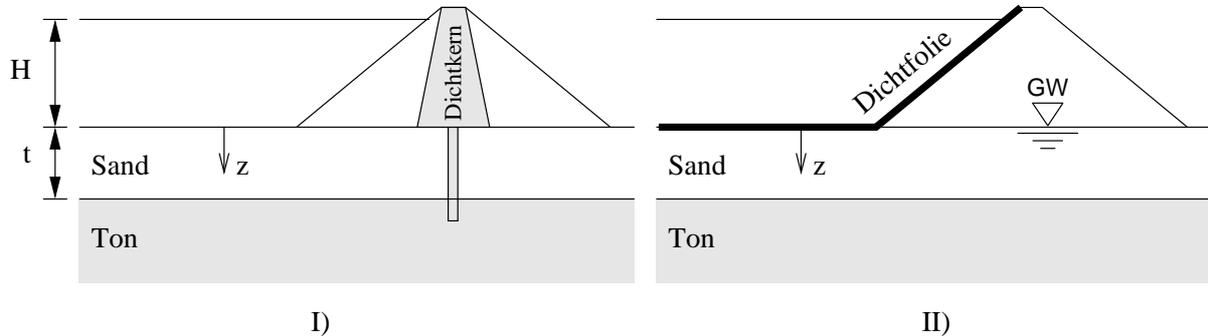
Berechnen Sie die effektiven und totalen, vertikalen und horizontalen Spannungen sowie den Porenwasserdruck für  $z = 0$  und  $z = t$  für die beiden Fälle a)  $H = 2,5$  m und b)  $H = 0$  für beide oben dargestellte Speicherbecken I) und II). Die Dicke der Sandschicht ist  $t = 1,5$  m,
