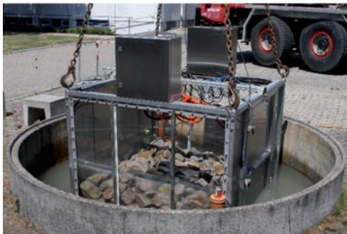
Bild 2: Versuchskasten mit Deckwerk im Tauchbecken.
