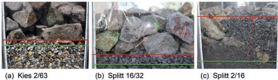
Bild 7: Filtereintrag nach 100 Zyklen für die drei Filterkörnungen.
