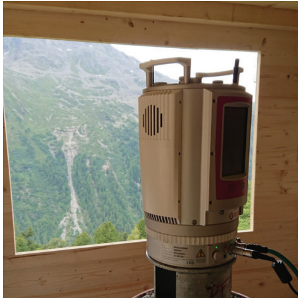
Bild 2: In der Messhütte: Scanner auf Betonsockel (von Hütte entkoppelt), Blick auf das Untersuchungsgebiet (Datum 15.07.2020).
