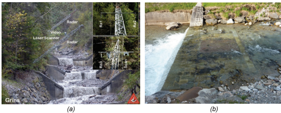
Bild 2, (a) Murenmonitoring Station am Lattenbach (Pians, Tirol), (b) Geschiebemesstation an der Urslau, Maria Alm
