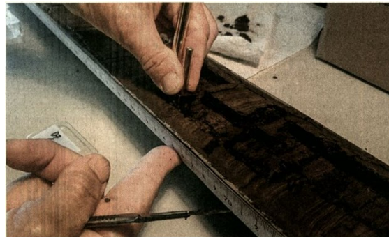
Hier wird ein Bohrkern inspiziert, aus dem Proben für die Pollenanalyse entnommen werden. BILD: SN/NHM WIEN/UNI INNSBRUCK
