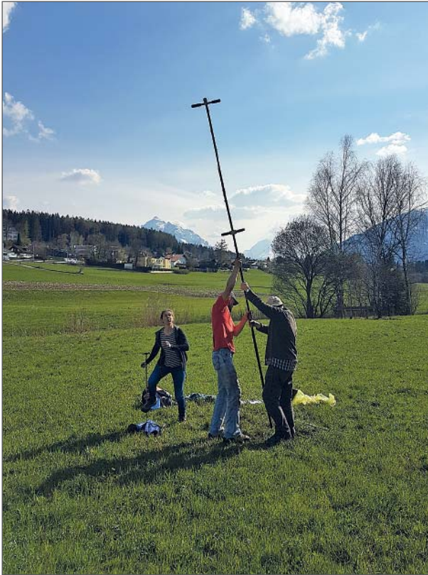
Abb. 5: Sondierungen mit Materialentnahme im Viller Moor, das unter der aktuellen Situation noch im Mittel eine Torfmächtigkeit von 3,75 m aufweist.
