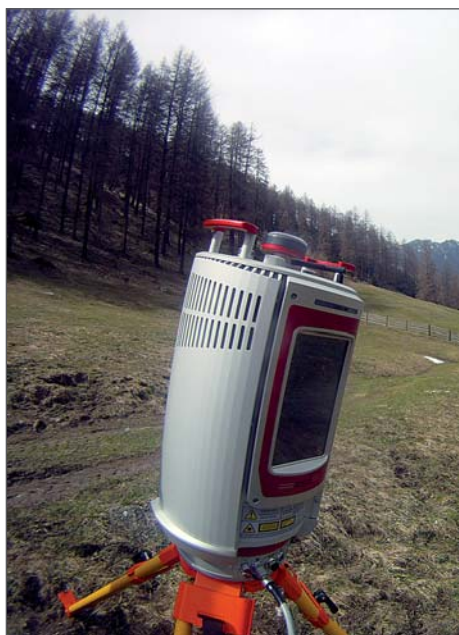
Abb. 4: Aufnahme des Lärchenbestands mit dem terrestrischen Laserscanner Riegl VZ 6000 (Foto: Bremer).
