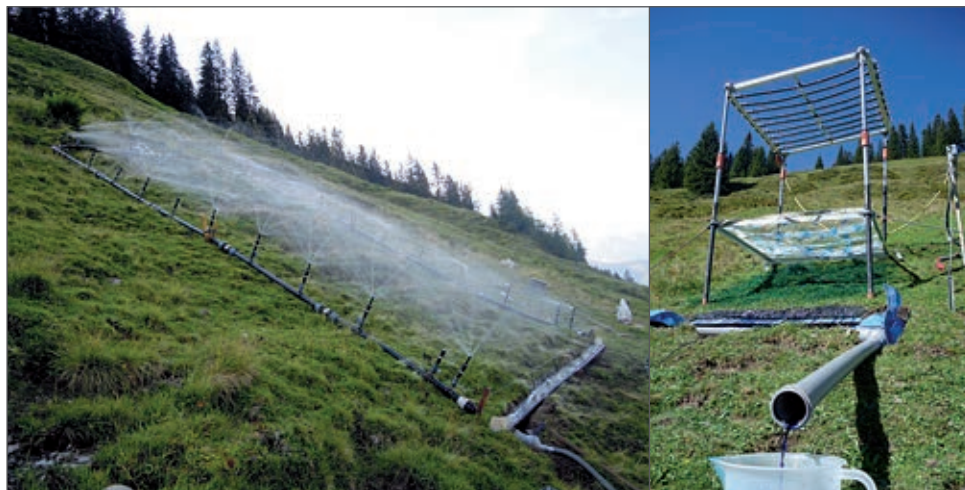
Abb. 2: Starkregensimulationen auf der Talkaseralm: links Großberegnungsversuch (BFW, 50 m 2 ), rechts Kleinberegnungsversuch (1 m 2 ), Wasser mit Brillantblau gefärbt, um die Fließwege im Boden sichtbar zu machen (Fotos: links R. Ruggenthaler, rechts C. Mayerhofer).
