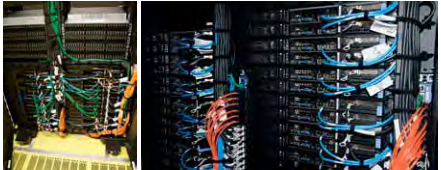
Leo III, das sind 1944 Prozessorkerne mit einer Rechenleistung von ca. 20 Teraflops.
