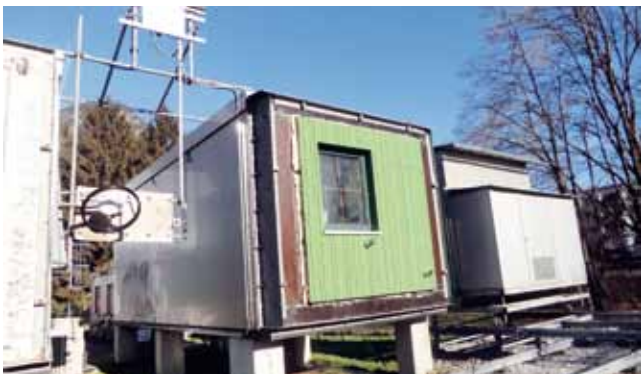
Fassadentestmodul am Campus Technik der Universität Innsbruck
