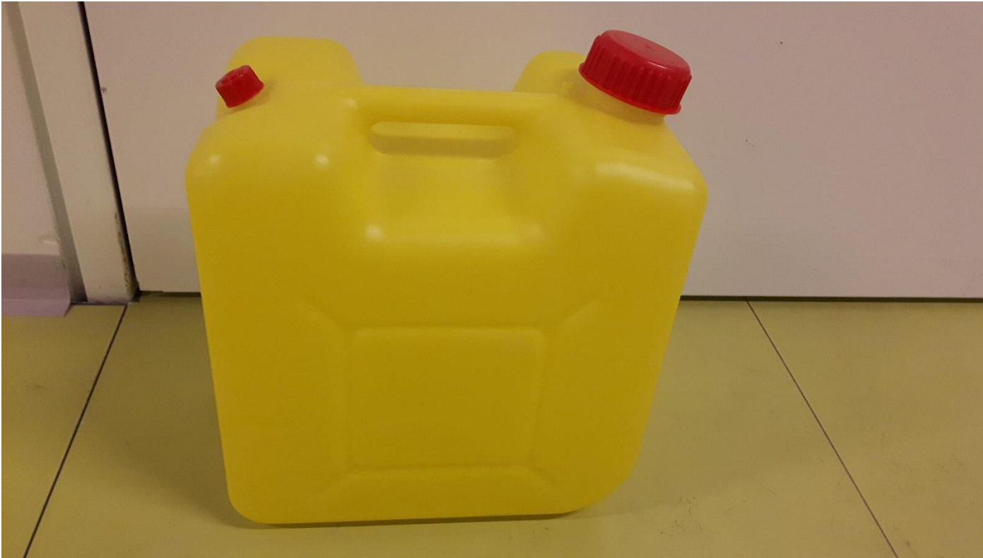
Lösungsmittelabfallkanister zum Ausleeren und Wiederverwenden. 10L
