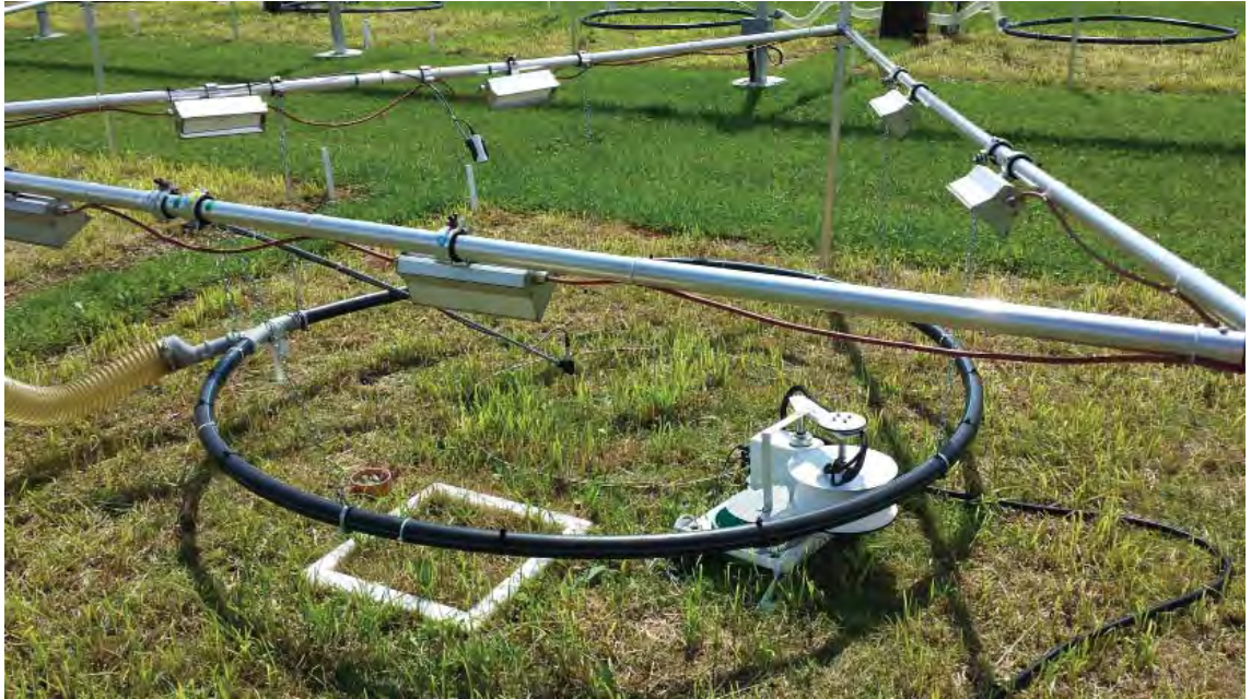
ClimGrass Versuchspazelle mit Begasungsring, IR-Beheizung, Bodenatmungskammer und NEE-Rahmen Foto: David Reinhaller
