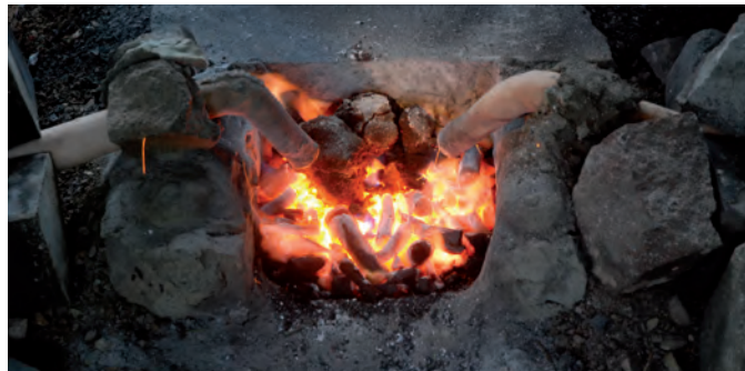
Abb. 1 Aufschmelzen des Erzes im Ofen mittels Keramikdüsen
