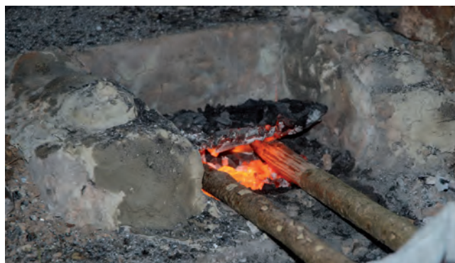
Abb. 2 Abheben der Schlacke vom Kupferstein mit Holzstangen
