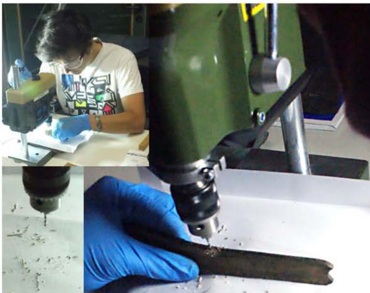
Abb. 1 Beprobung eines bronzezeitlichen Beils im Vorarlberg Museum; rechts unten die frisch gewonnenen Metallspäne für die Röntgenfluoreszenz- bzw. Bleisotopenanalyse. Fotos: Institut für Archäologien, Universität Innsbruck.
