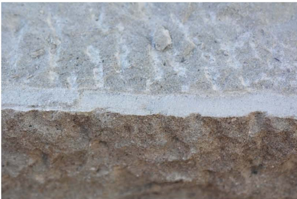
Abb. 1: Meißel- (Vordergrund) und Spitzmeißelspuren (Hintergrund) bei der ersten Profilierung der experimentell hergestellten Stele. Foto: V. Belfiore.
