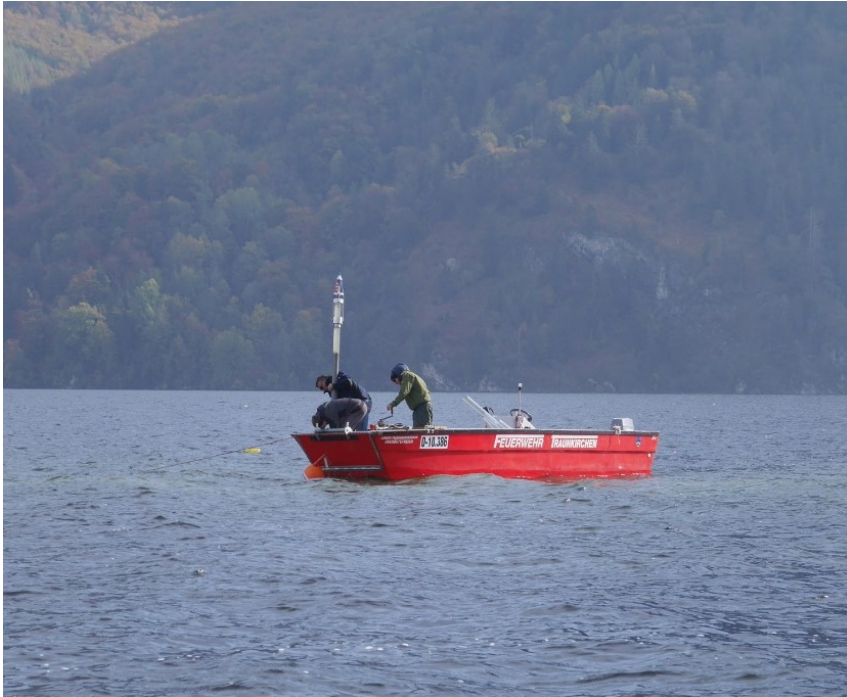
Abb. 6. Unterwasser-Bohrungen mit der Rammkernsonde von einem Arbeitsboot aus (Foto: Lisa Niederwieser, © Institut für Archäologien, Universität Innsbruck).
