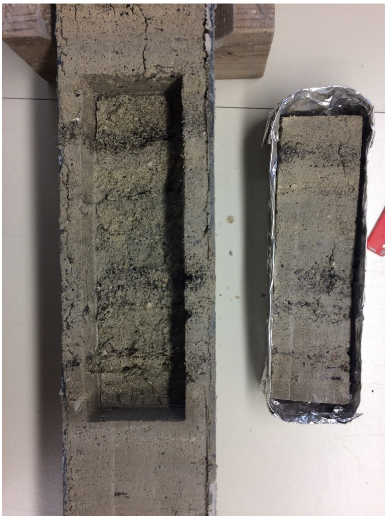
Abb. 13. Entnahme von Sedimentblöcken zur mikromorphologischen Analyse (Foto: Susanna Cereda, © Institut für Archäologien, Universität Innsbruck).
