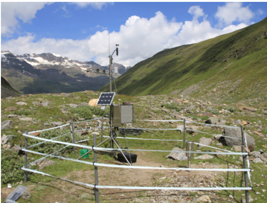
Abb. 14 & 15: Die Wetterstation an der Gletscherendmoräne von 1923 im Sommer (links) und im Winter (rechts). Die Schneestange (auf dem rechten Bild im Vordergrund) verfügt über eine Skalierung. Diese wird von einer automatischen Kamera regelmäßig fotografiert, um die Schneehöhe zu dokumentieren.
