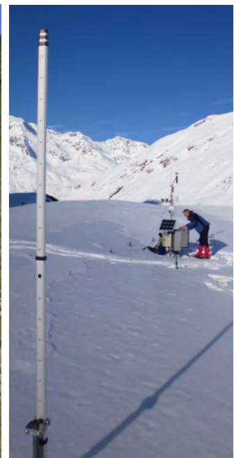
Abb. 14 & 15: Die Wetterstation an der Gletscherendmoräne von 1923 im Sommer (links) und im Winter (rechts). Die Schneestange (auf dem rechten Bild im Vordergrund) verfügt über eine Skalierung. Diese wird von einer automatischen Kamera regelmäßig fotografiert, um die Schneehöhe zu dokumentieren.
