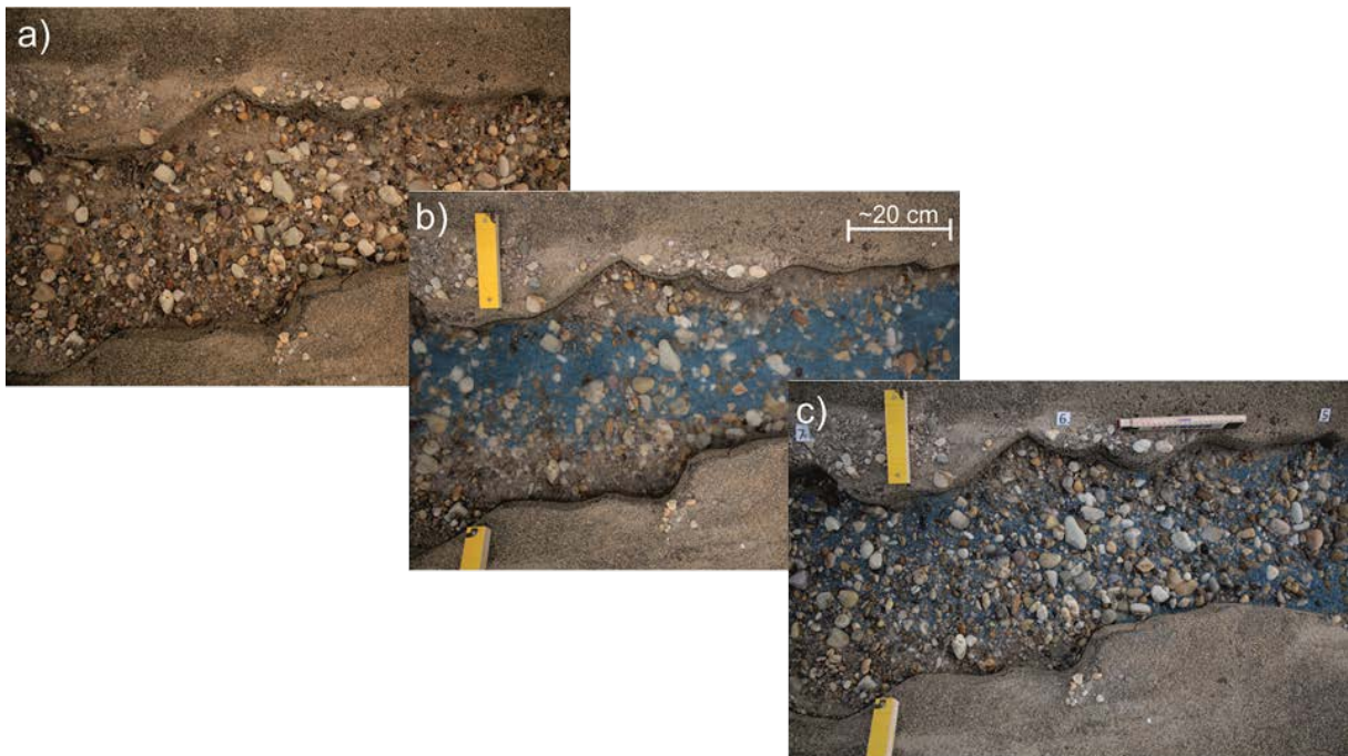
Abbildung 2: Fotosequenz während eines Modellversuchs in dem blau eingefärbtes, relativ feines Sediment zugegeben wurde: a) vor, b) während und c) nach dem Versuch mit einer Wasserführung von 4 Liter pro Sekunde
