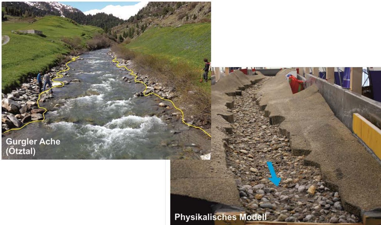
Abbildung 1: Die Untersuchungsstrecke an der Gurgler Ache in Realität (links) und im 1:20 skalierten Modell (rechts)
