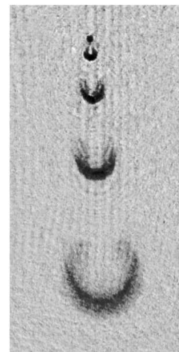
Abb.3: Nachweis der Kohärenz und erster Atomlaser in Ketterles Experimenten am MIT. Das obere Bild zeigt ein Interferenzmuster von zwei frei expandierenden Bose-Einstein-Kondensaten, die sich nach Abschalten der Falle überlagern [8]. Dies ist ein direkter Nachweis der makroskopischen Kohärenz eines BEC. Die destruktive Interferenz von Atomen („Atom + Atom = nichts!“) ist eine drastische und verblüffende Demonstration der Wellennatur von Materie. Das untere Bild zeigt die Auskopplung von kohärenten Materiewellenpaketen aus einem BEC [9], die sich unter dem Einfluss der Gravitation nach unten bewegen. Diese Experiment stellt eine erste Realisierung eines gepulsten Atomlasers dar. Die auffällige sichelförmige Gestalt der Atomlaserpulse entsteht durch die Wechselwirkung des fallenden Pulses mit dem BEC kurz nach der Auskopplung. (Bilder: MIT)
